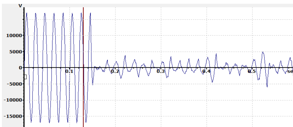
Slika 13. Napon faze u kvaru kod proboja na 20 kV SN postrojenju u mreži 4TS 23 Botinec
